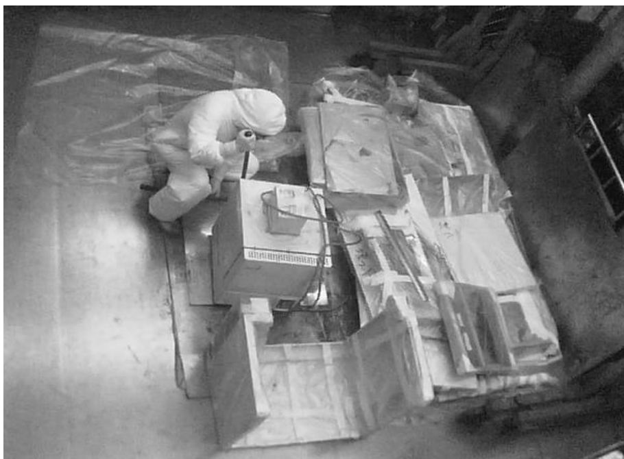
図 4.4.2-2 1m 3 角型鋼製容器の開梱汚染検査
