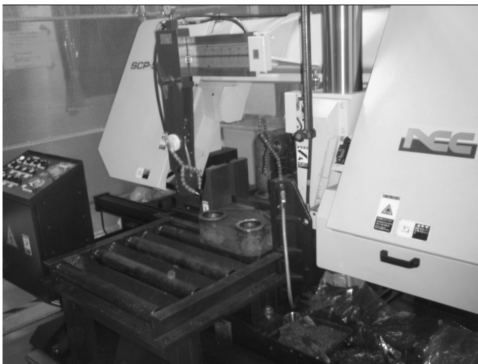
図 4.4.2-5 大型バンドソーによる切断
