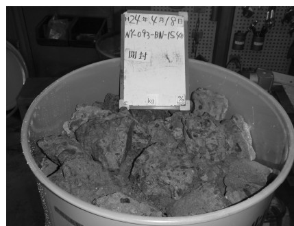
図 4.4.2-6 黒鉛、コンクリート廃棄物の収納状況
