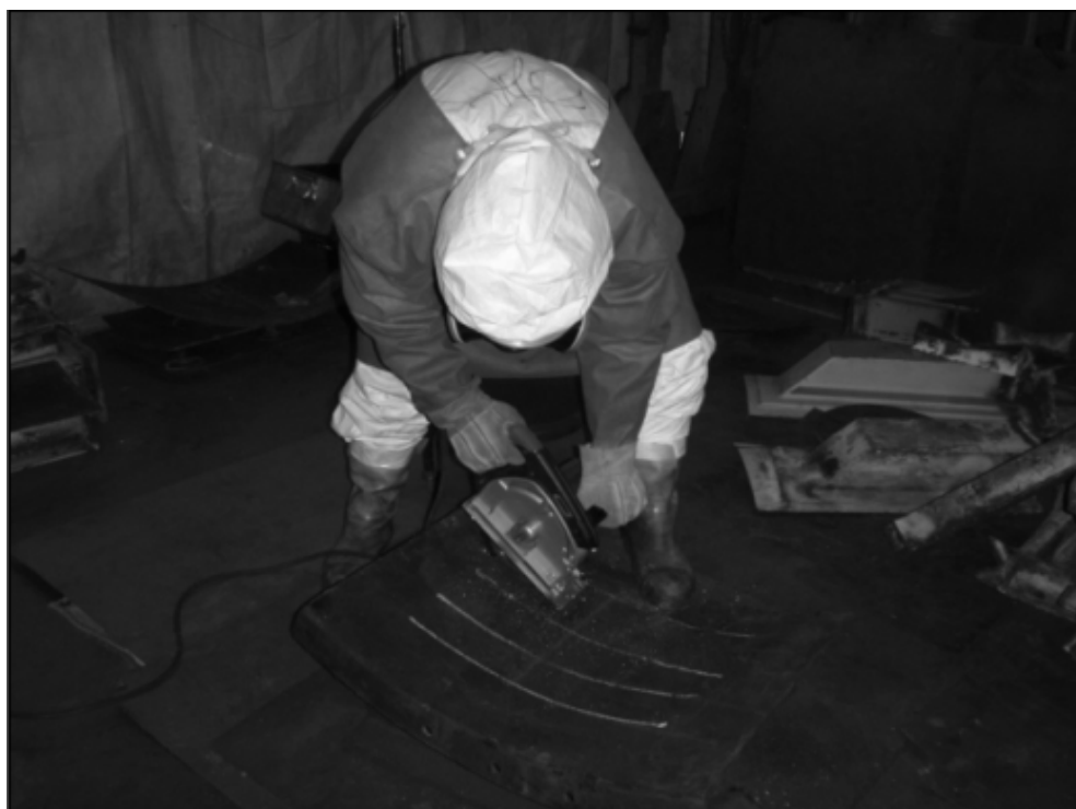
図 4.4.2-4 チップソーによる切断
