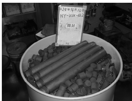
図 4.4.2-6 黒鉛、コンクリート廃棄物の収納状況
